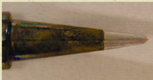
Forresúcs 20.000 forrasztás után, normál Sn60 ónnal
