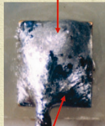
Túl sok ón, a huzal nem látható, az ón túlmelegedett
